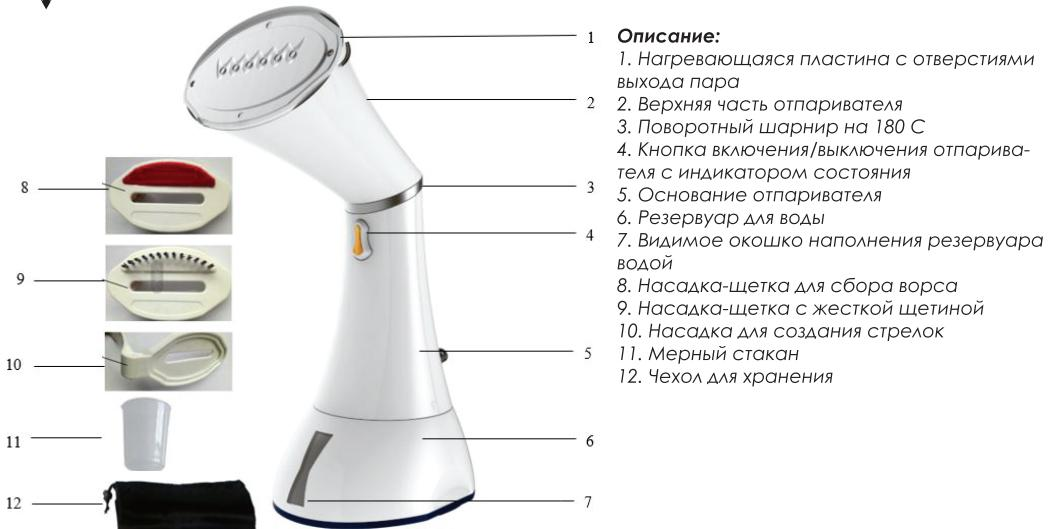
Отпариватель PROFFI PH8984 имеет в средней части корпуса нагревательный элемент, доводящий воду до состояния кипения. Далее горячий пар от кипящей воды поднимается в верхнюю часть отпаривателя и выходит из отверстий выхода пара. Благодаря конструкции корпуса отпаривателя, расширяющегося кверху, и особого строения верхней части отпаривателя создается плотный поток пара из отверстий выхода пара, которым можно отпаривать одежду и любые изделия из ткани.
